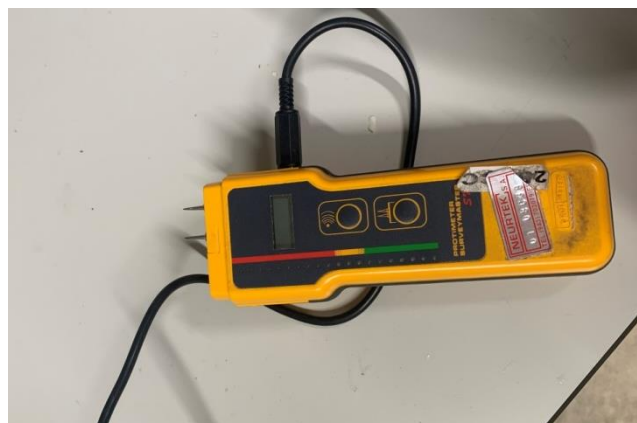
Figura 35. Medidor de humedad Surveymaster SM PROTIMETER.
