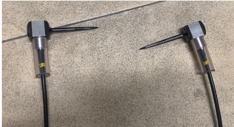
Figura 34. Sensor Fakopp SD-02.
