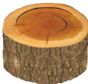
Figura 5. Acebolladura en madera. Fuente: https://sites.google.com/site/tecnologiadelamadera/
