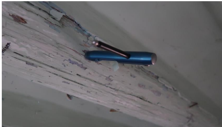
Figura 36. Barrena Trepbor 35 de 4mm para extracción de microcores.
