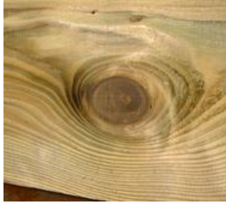
Figura 6. Nudo en madera. Fuente: https://normadera.tknika.eus/
