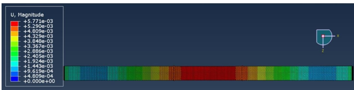
Figura 5.5.106. Desplazamiento en la cara superior de la viga reforzada con laminado de carbono.
