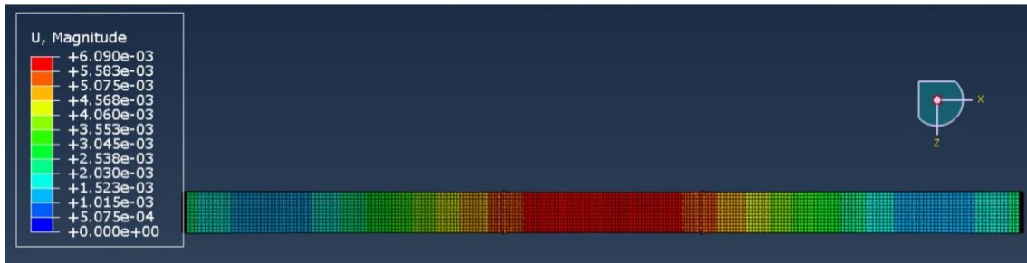
Figura 5.5.79. Desplazamiento en la cara superior de la viga reforzada con chopo.
