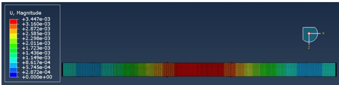
Figura 5.5.7. Desplazamientos en la cara superior de la viga compuesta con tejido de carbono.
