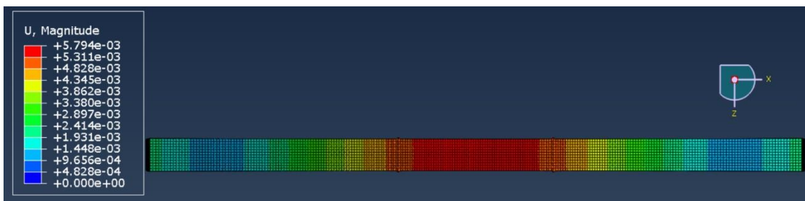
Figura 5.5.97. Desplazamiento en la cara superior de la viga reforzada con tejido de basalto.
