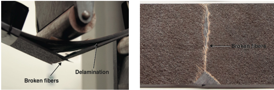
Figura 7.30. Fotografías de los daños producidos en la probeta 9_4.
