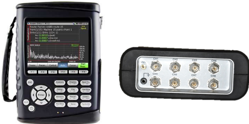
Figura 4.7. Vista general y vista del panel con los canales de entrada y salida del equipo CoCo80 .
