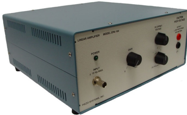
Figura 4.8. Amplificador lineal piezoeléctrico EPA 104 [150].
