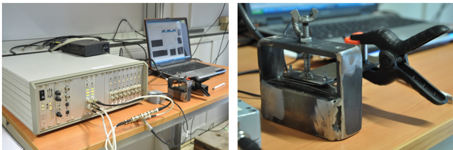
Figura 6.33. Vista del ensayo de delaminación pura.
