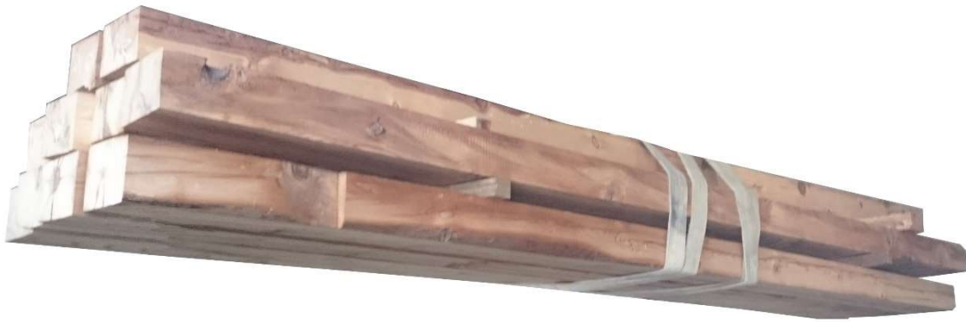
Figura 5.6 Fotografía de las vigas de gran escuadría acopiadas y sin reforzar.
