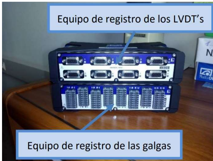
Figura 5.18 Equipo de registro MX 840 B de HBM para galgas extensiométricas y LVDTs [3].
