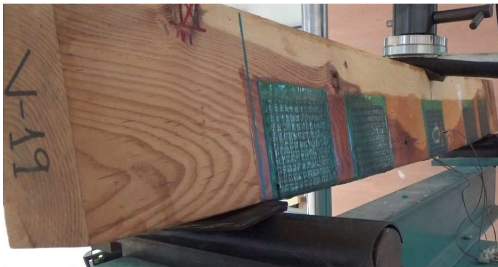
Figura 6.21 Fotografía de la viga BR-B-1 rotando sobre su eje longitudinal en el ensayo.
