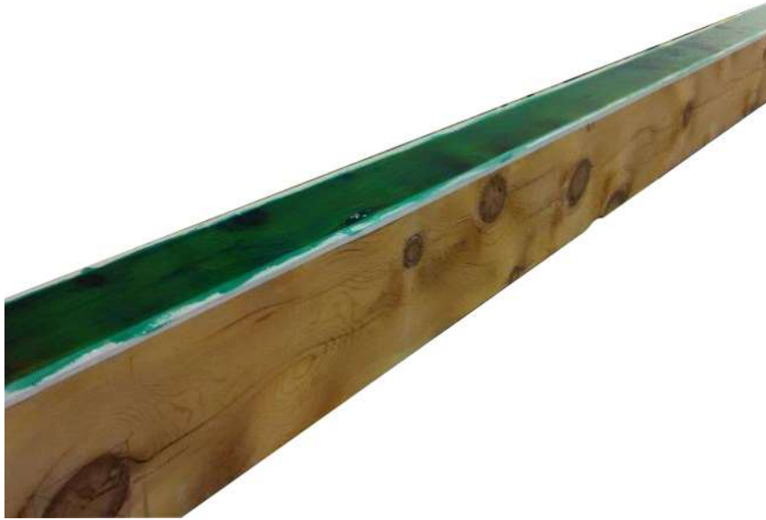
Figura 4.4 Aplicación de la resina sobre viga de gran escuadría.
