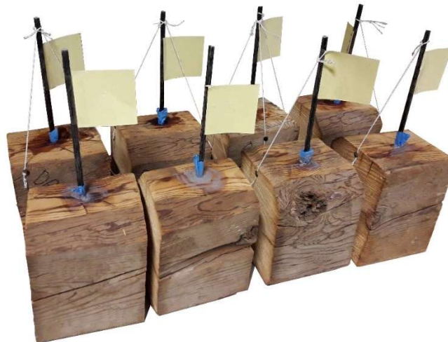
Figura 7.10 Curado de las probetas en una sala acondicionada.
