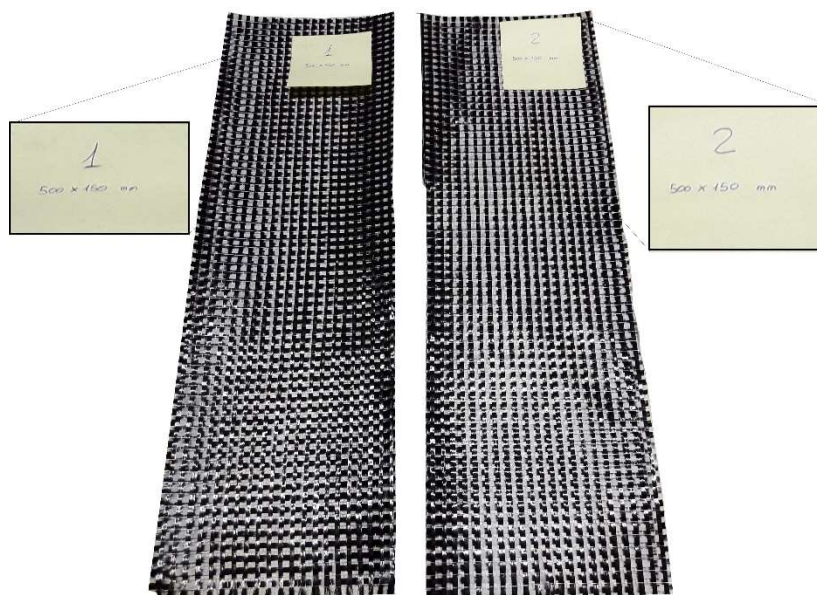
Figura 7.21 Corte y marcado de las piezas 1 y 2 de tejido de CFRP para la elaboración del refuerzo de la viga a rehabilitar.
