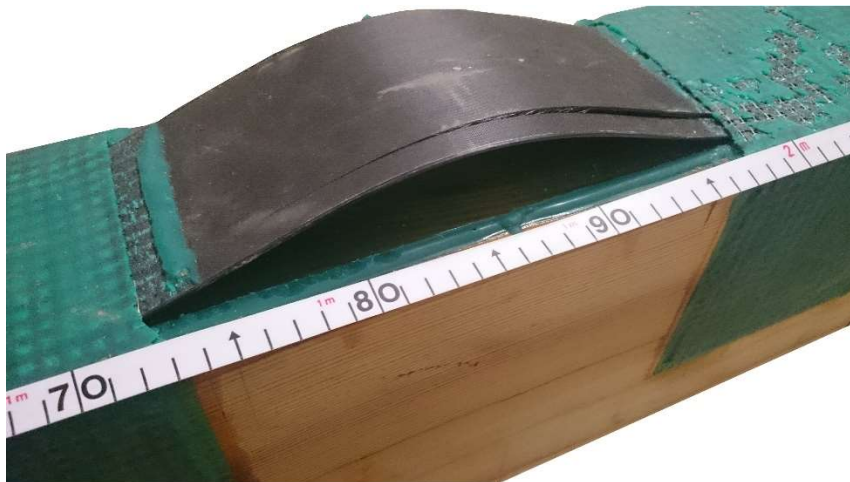
Figura 6.45 Fotografía de la deslaminación producida en la viga BR-2.
