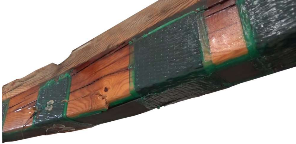
Figura 6.16 Fotografía de la rotura por tracción y cortante de la viga BR-U-3.
