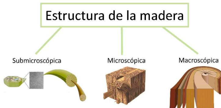
Figura 2.1 Estructura sub-microscópica, microscópica y macroscópica de la madera.
