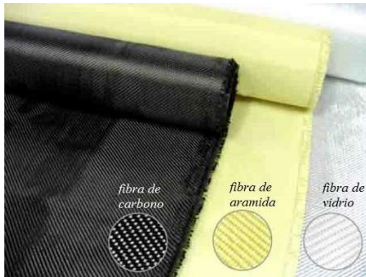
Figura 3.1 Diferentes tipos de fibras. Negro: fibra de carbono. Amarillo: fibra de aramida. Blanco: fibra de vidrio.
