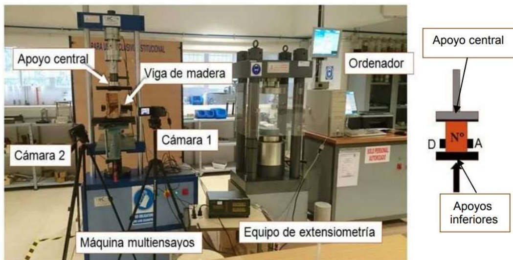
Figura 5.10 Montaje completo de un ensayo a flexión de una viga de pequeña escuadría [2].
