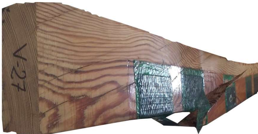
Figura 6.8 Fotografía de la rotura por cortante de la viga BR-U-1.
