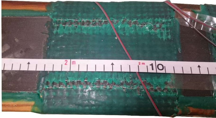
Figura 6.40 Fotografía del desgarro sufrido por el tejido de CFRP de la viga BR-1.
