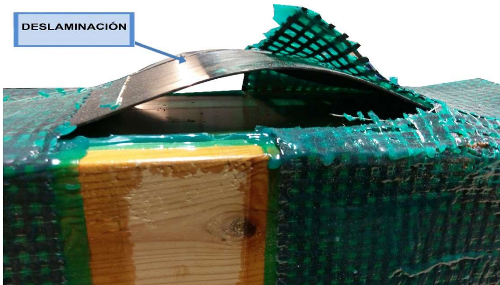
Figura 6.50 Deslaminación de la viga BR-r-1 tras su rotura.
