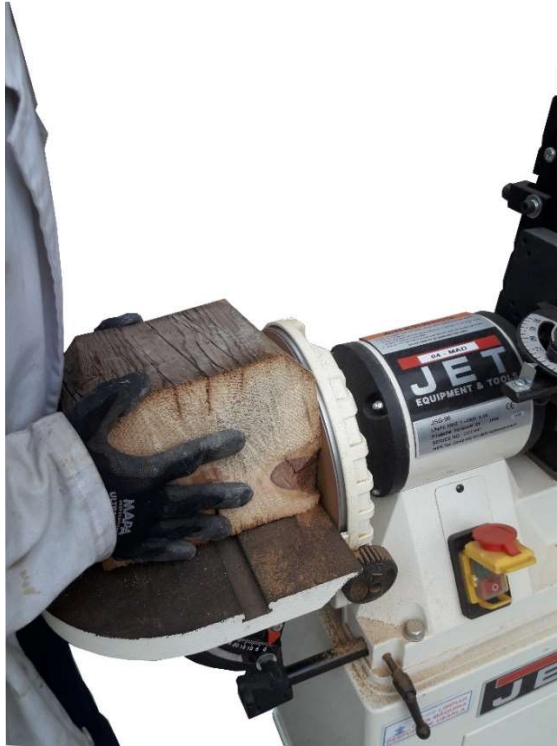
Figura 7.4 Lijado y cepillado de probeta para su acondicionamiento.
