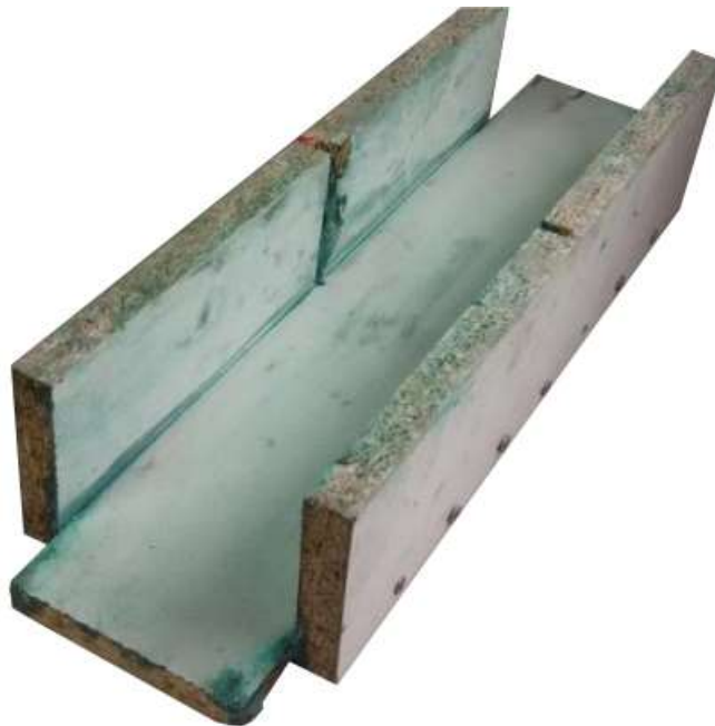
Figura 4.5 Dosificador de resina para el laminado CFRP.
