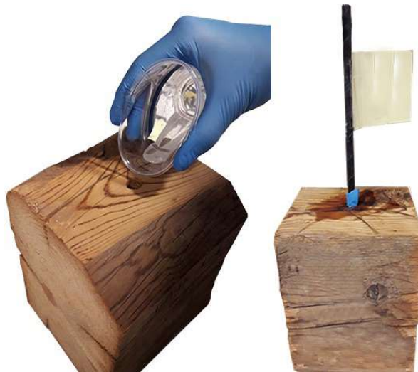
Figura 7.7 Izquierda: vertido de la resina Tipo 6 en el agujero de la pieza de madera. Derecha: Inserción de la varilla de fibra de vidrio en la pieza de madera.
