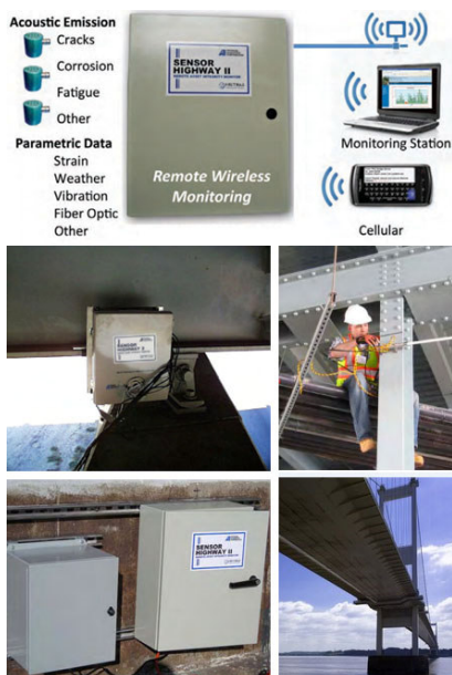
Figura 2.1: Ejemplos de sistemas de evaluación en tiempo real mediante el método de EA de la empresa MISTRAS.
