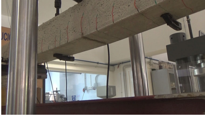
Figura 5.45: Estado de la viga sin muesca tras el ciclo 5.
