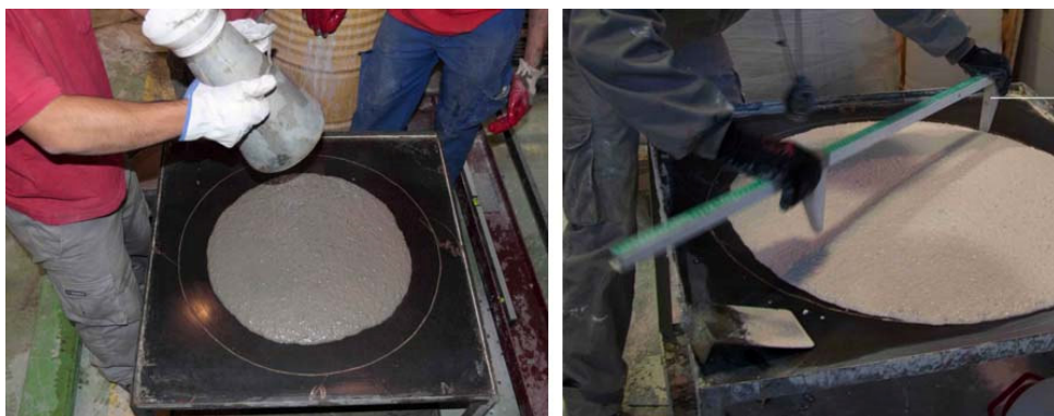
Figura 8.1: Izqda.: Ensayo de escurrimiento. Dcha.: Comprobación de la medida en el ensayo de escurrimiento.
