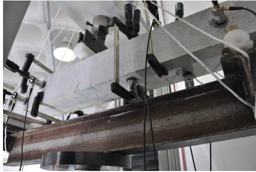
Figura 5.52: Estado de la viga sin muesca tras el ciclo 3.
