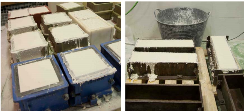
Figura 8.4: Hormigonado de probetas. Izqda.: Cúbicas. Dcha.: Prismáticas.
