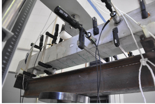
Figura 5.54: Estado de la viga sin muesca tras el ciclo 4.
