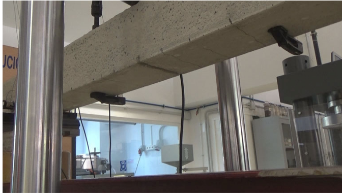
Figura 5.41: Estado de la viga con muesca tras el ciclo 3.
