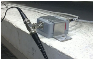
Figura 4.34: Conexión BNC en T para la unión de dos sensores a un único preamplificador.
