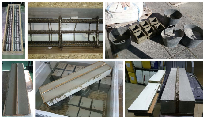
Figura 4.6: Proceso de elaboración, hormigonado, curado de las vigas sin muesca y su estado final.
