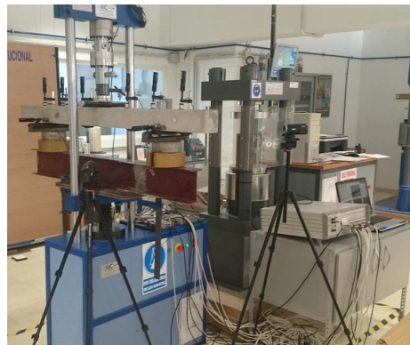
Figura 4.19: Fotografía general del ensayo a flexión a tres puntos de la viga con muesca.
