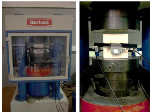
Figura 8.5: Izqda.: Máquina de la casa comercial Ibertest para ensayos a compresión. Dcha.: Probeta cúbica de hormigón instrumentada con EA.
