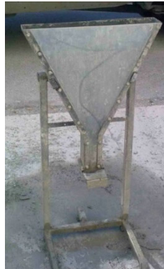
Figura 8.2: Ensayo del embudo.
