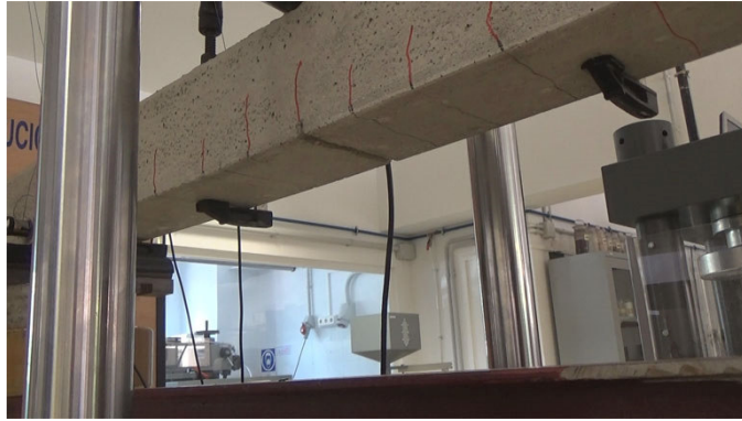
Figura 5.43: Estado de la viga sin muesca tras el ciclo 4.
