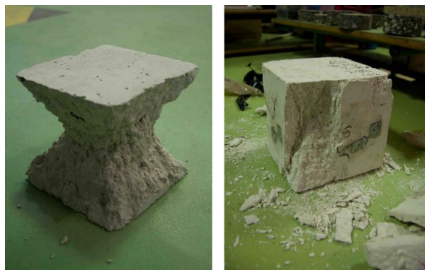
Figura 8.7: Ejemplos de rotura de probetas cúbicas. Izqda.: Satisfactoria. Dcha.: No satisfactoria.
