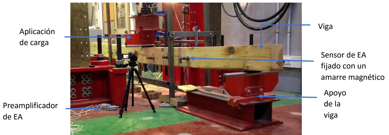
Figura 5.4. Ensayo a flexión de la viga LRS1.
