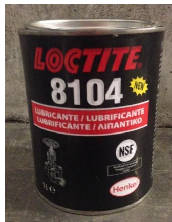
Figura 5.6. Grasa de silicona utilizada como acoplante acústico.
