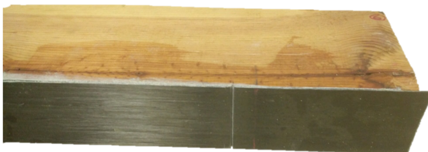
Figura 2.19. Fotografía de una viga con el refuerzo LR-S-F.
