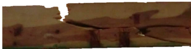
Figura 2.6. Fotografía del fallo por cortante de una de las vigas ensayadas.
