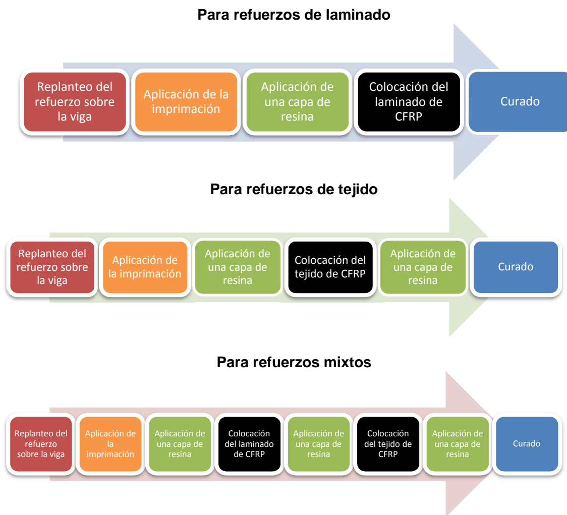
Figura 2.32. Proceso de elaboración de los refuerzos con CFRP
