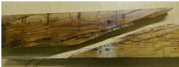
Figura 4.19. Rotura de la viga LR-S-P-2.
