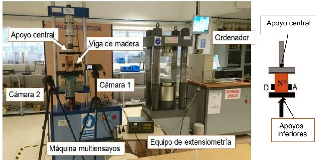
Figura 3.1. Montaje completo antes de un ensayo a flexión de una viga reforzada.
