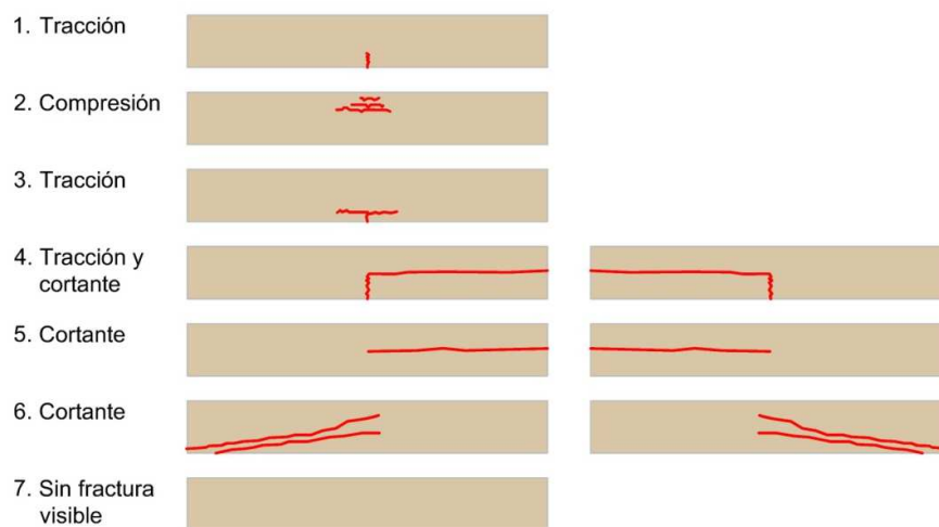
Figura 4.4. Modelos de fallo de las vigas ensayadas [3].
