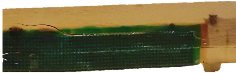
Figura 4.76. Rotura de la viga WLR-D-U-2.
