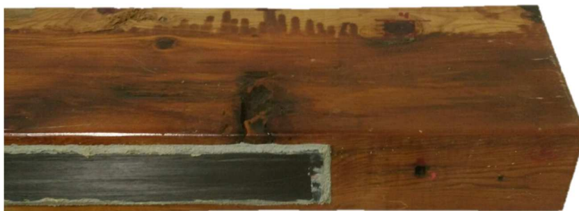
Figura 2.17. Fotografía de una viga con el refuerzo LR-S-P.
