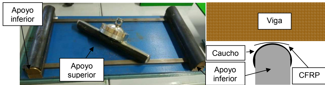
Figura 3.7. Izquierda: fotografía del apoyo central entre los apoyos laterales inferiores desmontados de la prensa. Derecha: esquema de un apoyo inferior y la protección contra hundimiento.
