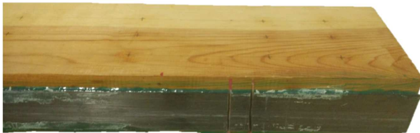
Figura 2.18. Fotografía de una viga con el refuerzo LR-D-P.
