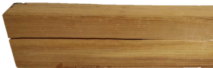
Figura 4.43. Rotura de la viga LR-D-P-3.
