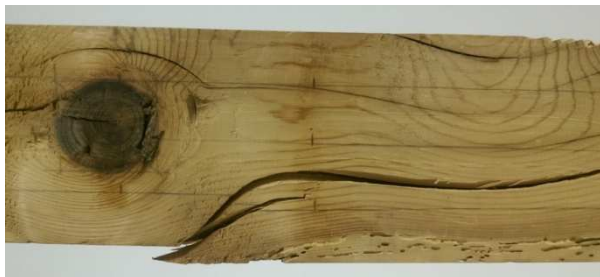
Figura 4.8. Rotura de la viga NR-2.
