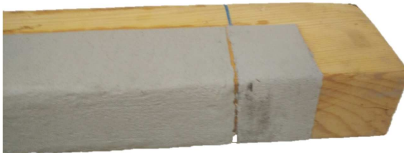
Figura 2.26. Fotografía de una viga con el refuerzo WLR-S.
