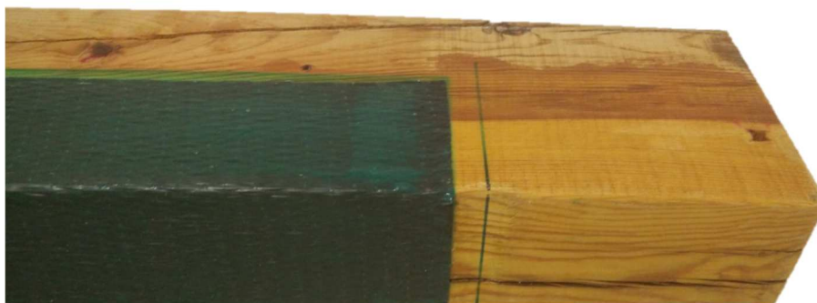
Figura 2.23. Fotografía de una viga con el refuerzo WR-D-U.
