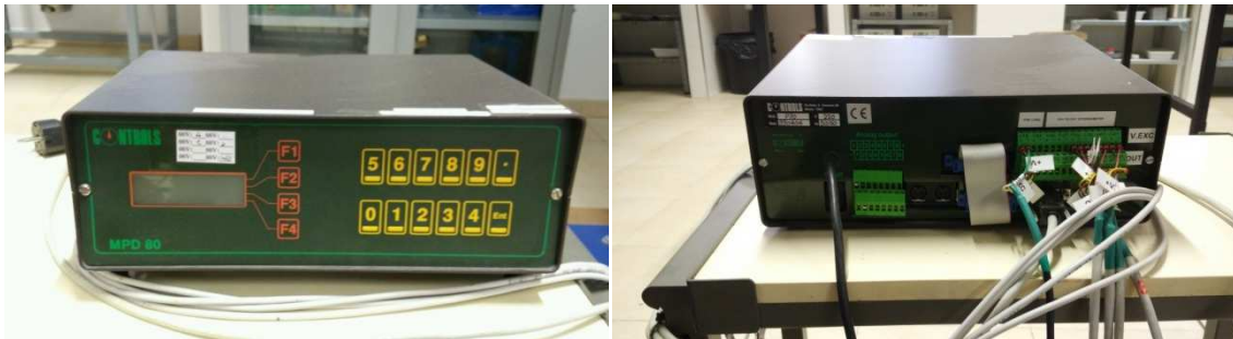
Figura 3.5. Equipo de extensimetría CONTROLS P70 (Milan-Italia). Izquierda: frontal. Derecha: parte trasera.
